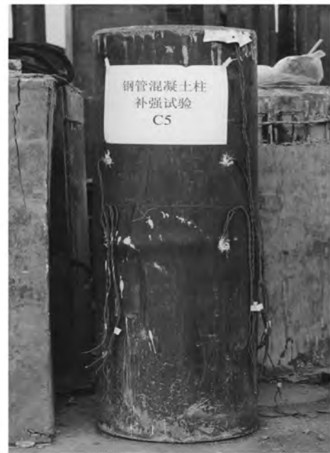
(d) Local buckling of steel tube
