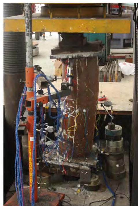
(d) Photo of eccentric compression specimen
