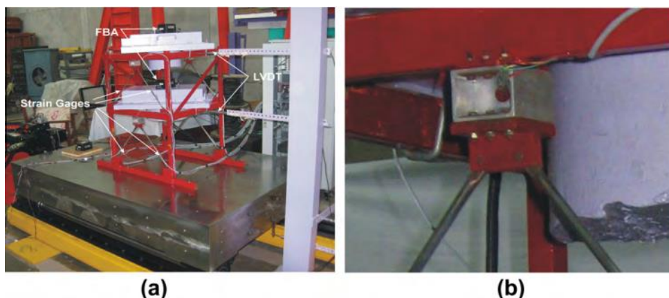
شکل 7. (a) نمونه نصب شده روی جدول لرزه (b) نمای نزدیک رابط برشی
