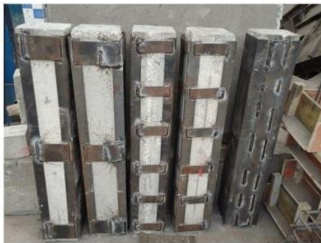
Fig. 2 نمونه تقویت شده پس از قالب گیری و نصب ژاکت
