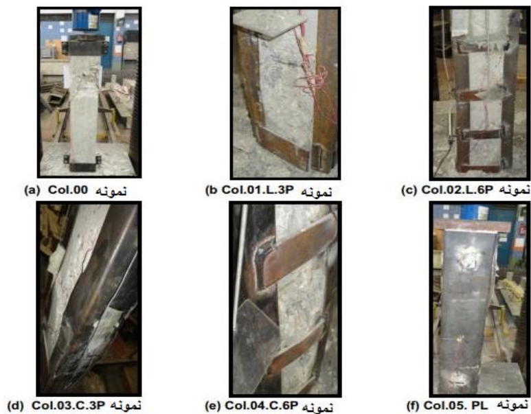
Fig. 14 شکست در تمامی نمونه های آزمایش شده
