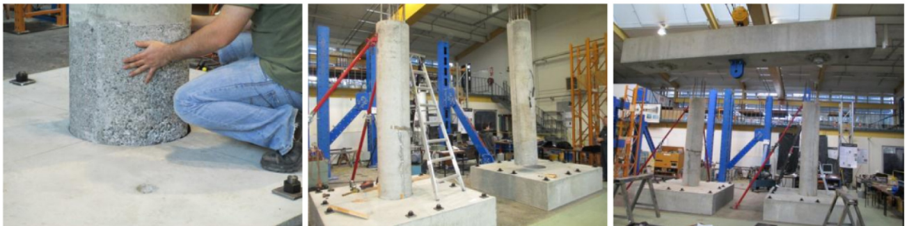
(d) Roughened Surface of Column
