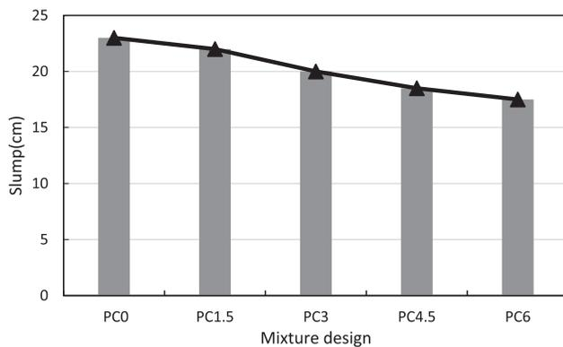
Fig. 6. Slump test result.
