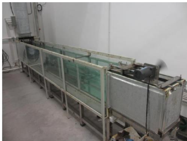
شکل 1. سرریز موج برای آزمایش شبیه‌سازی نشت نفت دور از ساحل
