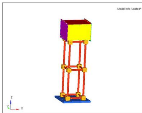
شکل 6: مدل المان محدود خریای فضاکار اصلی و سازه بار هوافضا
