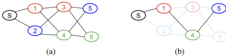
شکل 1: (a) آرایش با چندین گروه سنسور همبستگی (علامت گذاری شده با رنگ) و (b) پوشش کل محدوده ی نظارت از طریق یک زیرمجموعه از گره های متصل شده ی فعال
