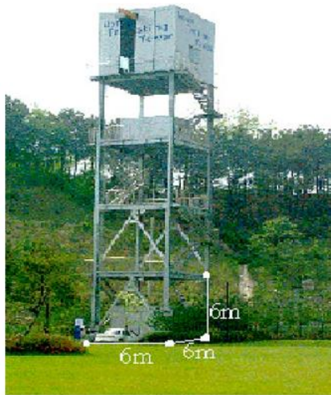
شکل 3. مدل سازه ی دارای مقیاس اصلی برای تست ها.
