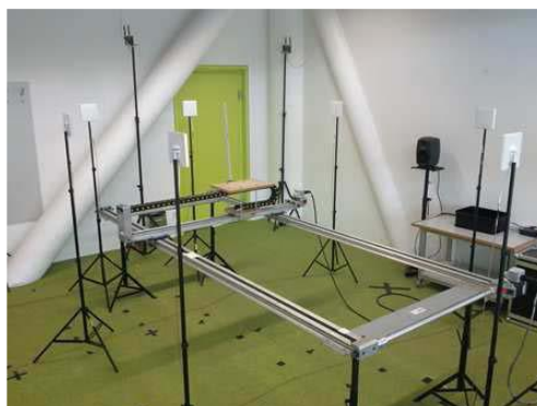
شکل 8. راه‌اندازی سنجش سیستم مکان‌یابی برای ترانسپندر UHF RFID شامل k=8 فرستنده و گیرنده مرتبط با کاربر
