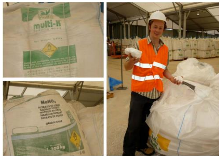
شکل 5: پتاسیم و نیترات سدیم قبل از فرآیند ذوب. در حالت مایع با یک رنگ زرد مانند آبجو روشن است
