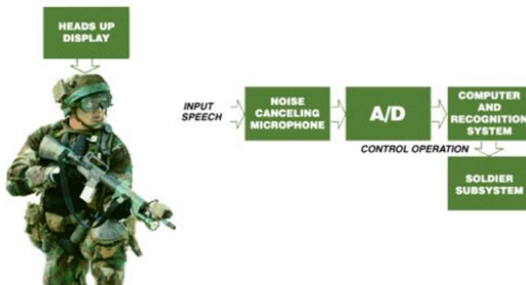
شکل 2) دیاگرام بلوکی کنترل صدای سیستم
